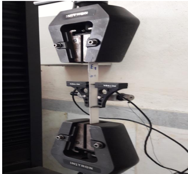
شکل ۳. تجهیزات و نحوه‌ی انجام تست خواص
