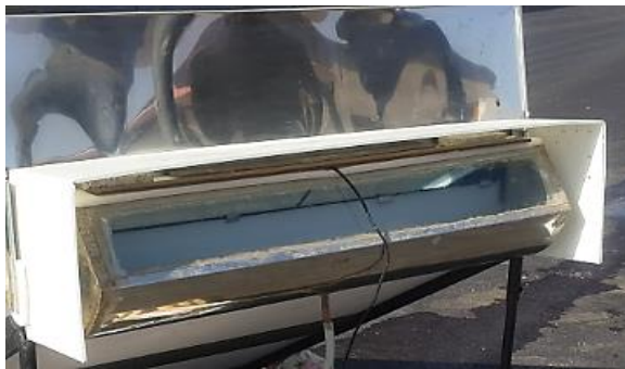
شکل ۴: چگالنده آب شیرین کن به همراه سایه بان
