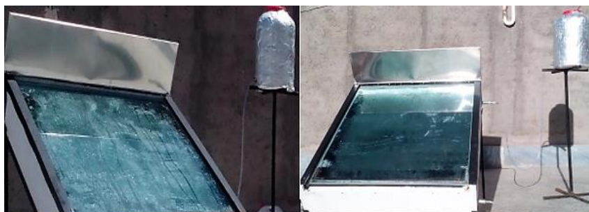
شکل ۲: نمایی از آب شیرین کن آبشاری ساخته شده
