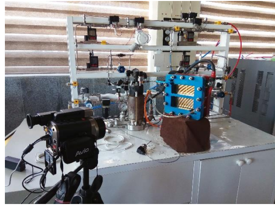
شکل ۱۰: نمایی از سیستم تست پیل سوختی به همراه دوربین حرارتی و نرم افزار کنترل تست
