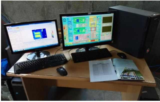
شکل ۱۰: نمایی از سیستم تست پیل سوختی به همراه دوربین حرارتی و نرم افزار کنترل تست
