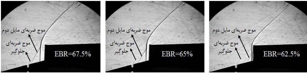
شکل ۱۳: اثر نسبت انسداد خروجی بر امواج ضربه‌ای برای دهانه مکش باریک در عدد ماخ ۲/۰
