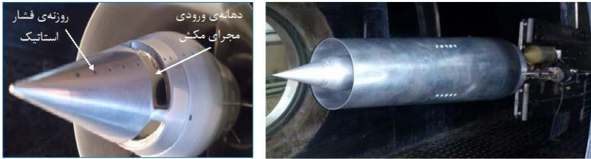
شکل ۴: مدل ورودی هوا داخل تونل باد [۲]
