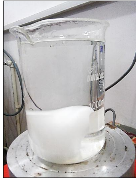
شکل ۱ پلی اتیلن گلیکول ۶۰۰ در دو حالت مایع و جامد Fig. 1. Poly Ethylene Glycol (PEG) 600 in solid and liquid states
