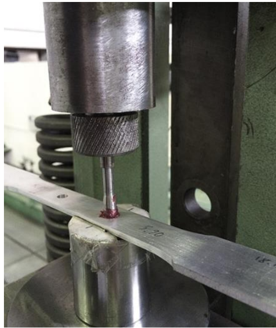
شکل ۴: عملیات انبساط سرد توسط پین بر روی فیکسچر مخصوص
