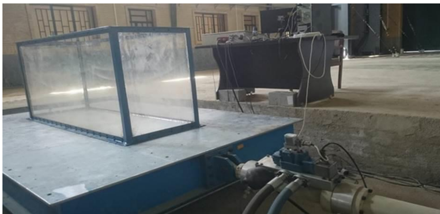
شکل ۱. محفظه مدل بر روی میز لرزه Fig. 1. Model container on the shaking table
