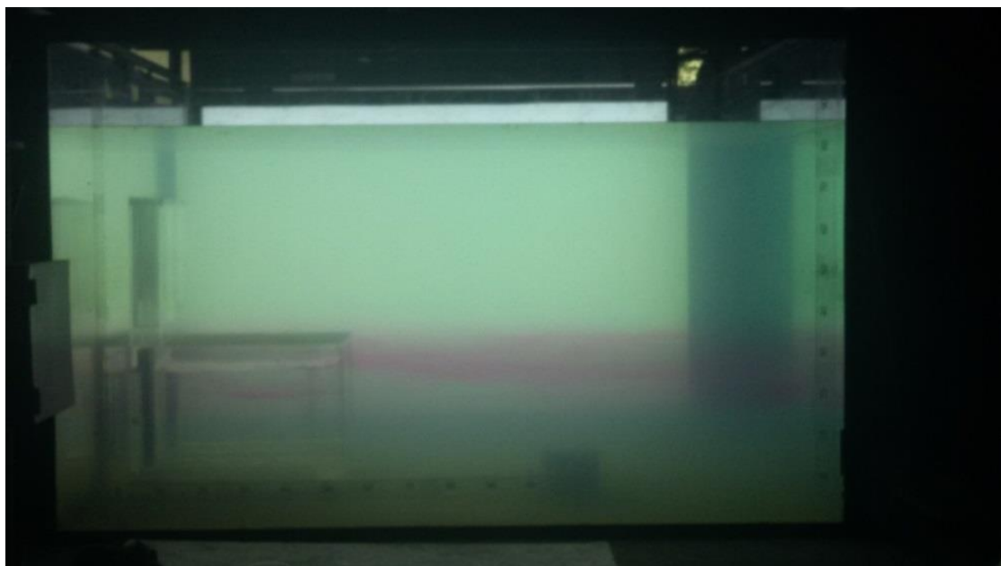
شکل ۱۶. الگوی رنگ تزریق شده در موقعیت دوم، ۱۹ ساعت و ۲۱ دقیقه پس از پایان آزمایش Fig. 16. Pattern of tracer(streamline) in the second position, 19 hours and 21 minutes after the end of the test
