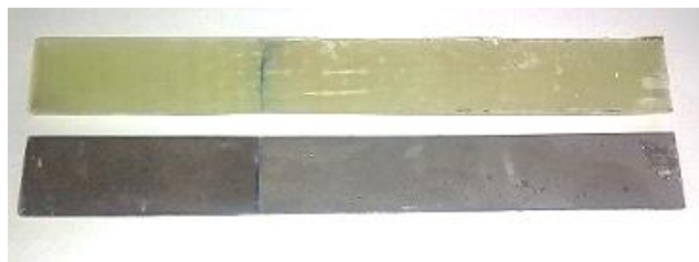
شکل ۱۷: سطوح شکست چندلایه کامپوزیتی و زیر لایه فولادی در نمونه خمشی انتها ترک‌دار متقارن
