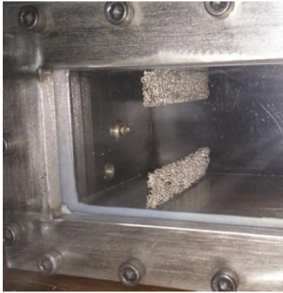
شکل ۳: تصویر مانع متخلخل در داخل محفظه در فاصله ۵ cm از محل جرقه
