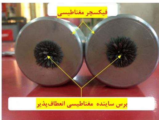
شکل ۲: نمای واقعی از نحوه شکل‌گیری برس ساینده مغناطیسی انعطاف‌پذیر در فرآیند پرداخت کاری ساینده مغناطیسی
