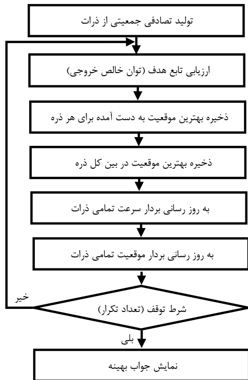
شکل ۴. فلوچارت الگوریتم بهینه‌سازی ازدحام ذرات Fig. 4. Flowchart particle swarm optimization algorithm
