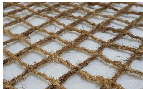
شکل ۲. مش الیاف خرما Fig. 2. Woven palm fibers mesh
