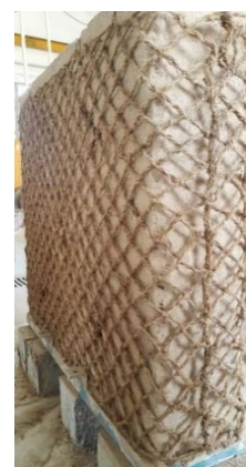
شکل ۳. تقویت نمونه W6 با مش الیاف خرما Fig. 3. Strengthening of W6 with palm meshes
