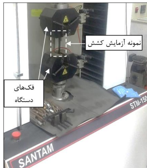
شکل ۳: نمونه کشش در بین فک‌های دستگاه Fig. 3. Gripped specimen during tensile test
