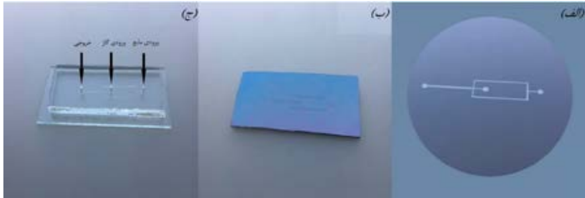
شکل ۲: الف: طرحواره دستگاه میکروسیالاتی جریان متمرکز ب: قالب فتورزیست که با تابیدن نور فرابنفش بر روی طرح قرار داده شده بر روی فیلم فتورزیست ظاهر می‌شود. ج: میکروسیال قالب‌گیری شده با پلی‌دی‌متیل‌سیل‌اکساین از روی قالب فتورزیست
