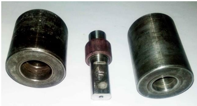
شکل ۴: فیکسچر مورد استفاده برای استخراج قطعات کوچکتر
