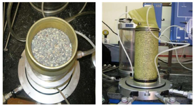
شکل ۵. آماده‌سازی نمونه دانه‌ای برای آزمایش سه محوری
