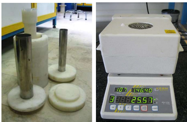
شکل ۸. الف) قالب تفلون به همراه لوله‌های ساخت ستون سنگی (ب) دستگاه رطوبت سنج اتوماتیک با دقت بالا Fig. 8. a) special molding for construction of stone columns and surrounding soil b) automatic high accuracy moisture balance device
