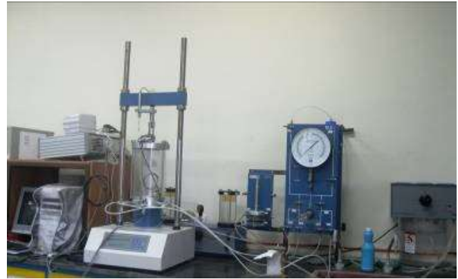
شکل ۲. دستگاه سه محوری مورد استفاده در این پژوهش Fig. 2. Triaxial testing device- Used in this research
