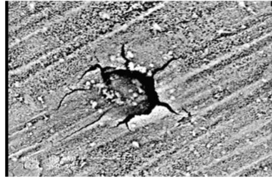
شکل (۱۲): سطح فلز کم آلیاژ استحکام بالا پس از انجام تست ZRA (الف) خوردگی عمومی (ب) خوردگی حفره‌ای
