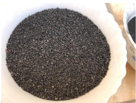
شکل ۴. تصویر سرپاره ذوب آهن آسیاب نشده Fig. 4. Picture of unmilled iron smelting slag
