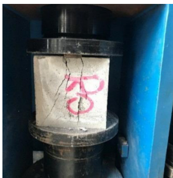
شکل ۱۵. شکافتن نمونه جهت بررسی عمق نفوذ Fig. 15. sample Split to Investigate penetration Depth
