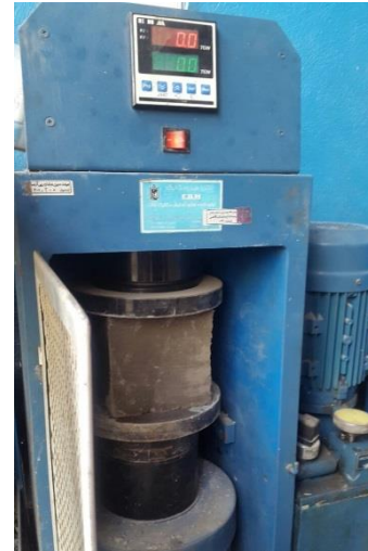
شکل ۶. نحوه قرارگیری نمونه زیر جک مقاومت فشاری Fig. 6. How to place the sample under the compressive strength jack
