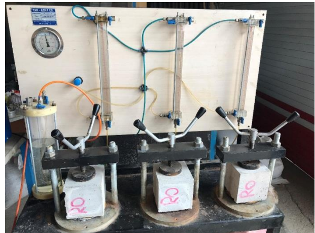
شکل ۷. قرارگیری نمونه ها در دستگاه نفوذپذیری تحت فشار Fig. 7. How to put the specimens in the pressure-permeable apparatus
