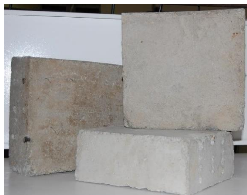
شکل ۵: بلوک‌های بتنی ساخته شده به همراه آرماتور نهفته در آن
