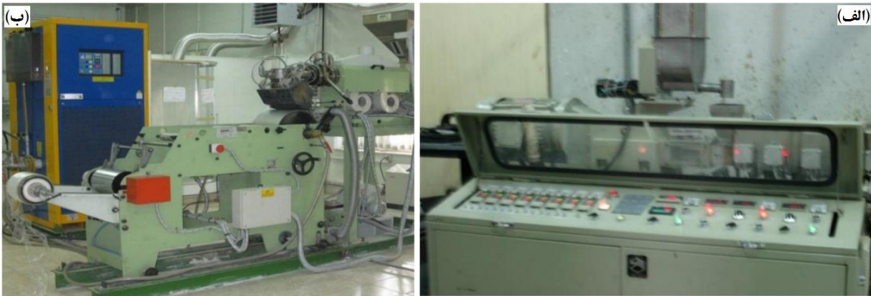
شکل ۱- الف) اکسترودر دو پیچه همسوگرد مدل اس‌ام شرکت پلاتک و ب) اکسترودر دو پیچه تولید فیلم با نام تجاری کاستینی Fig. 1. a) Co-rotating twin-screw extruder SM Model by PLATEK Co. and b) Co-rotating twin-screw extruder for film production by Castiny Co
