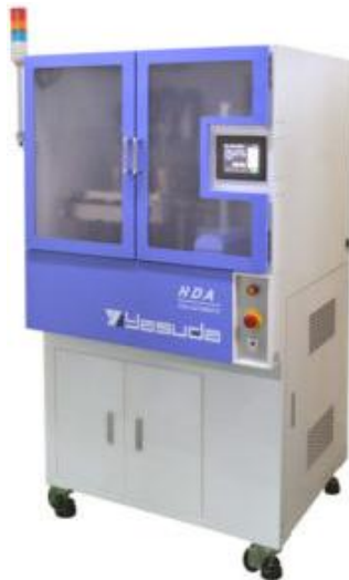
شکل ۴. شماتیک نحوه اندازه‌گیری دمای نرم‌شدگی وایکات و دستگاه مدل اچ‌دی-بی‌سی شرکت یاسودا ژاپن
