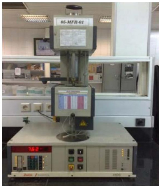
شکل ۳. دستگاه اندازه‌گیری شاخص جریان مذاب در این تحقیق مدل زوویچ ۴۱۶۰.
