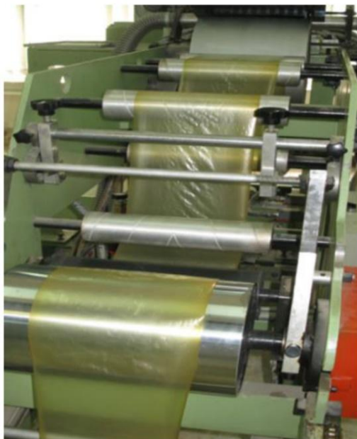
شکل ۲. نمونه فیلم کامپوزیتی پلی‌استایرن-نشاسته تهیه شده توسط غلطک‌های انتقال‌دهنده اکسترودر تولید فیلم
