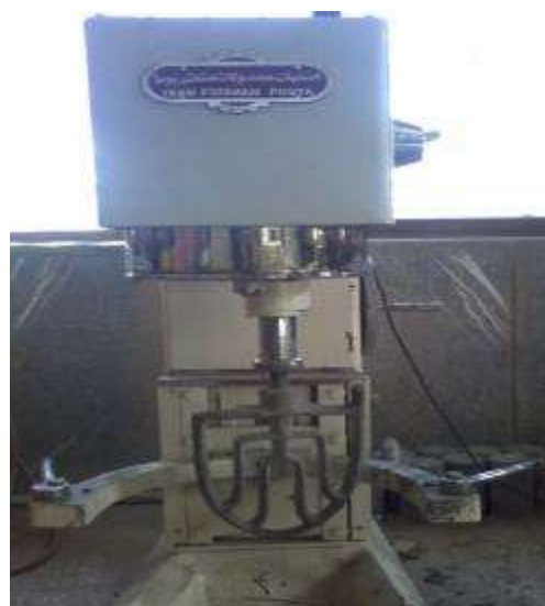
شکل ۳. مخلوط‌کن مورد استفاده در این تحقیق با حداکثر سرعت ۳۶۰ دور بر دقیقه.
