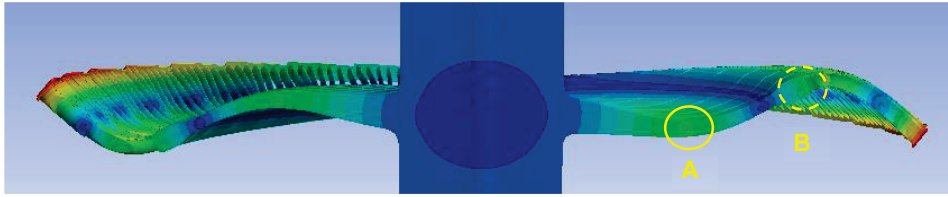
شکل ۹: مقطع شفت-دیسک-پره در مد قطری اول مد ۱۱؛ دایره موقعیت نصب چاه غیرخطی انرژی را نشان می‌دهند
