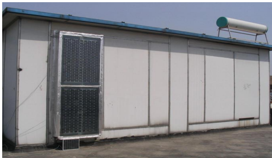
شکل ۲. تصویر دیوار خورشیدی مورد بررسی در تحلیل تجربی جی و همکاران [۶] Fig. 2. Picture of solar wall in experimental analysis of Jie et al. [6]
