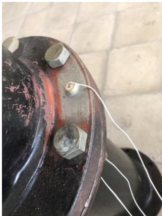
Fig. 3. Sensors and actuators connection on the flange شکل ۳: نحوه اتصال حسگرها و عملگرها روی فلنج
