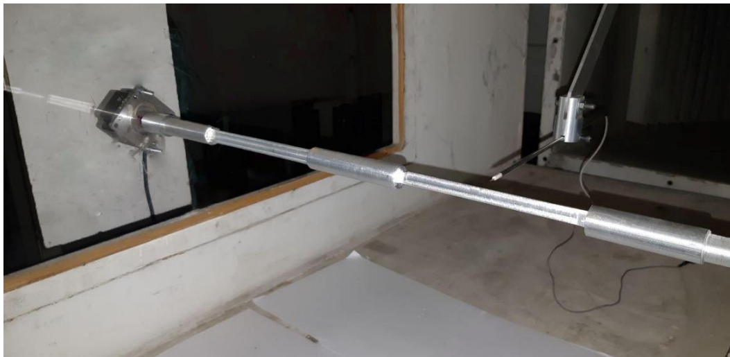
شکل ۴. مدل مثلثی متصل به موتور پله‌ای Fig. 4. Triangular model connected to a stepper motor
