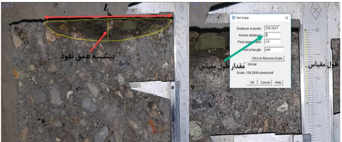
شکل ۳. طول مقیاس و سطح ترشدگی برای نمونه بتنی شکسته شده پس از اتمام آزمایش نفوذپذیری با استفاده از روش "محفظه استوانه‌ای" [۳۲]. Fig. 3. Scale length and wet surface for a concrete sample split in halves after completion of permeability test using "Cylindrical chamber" method
