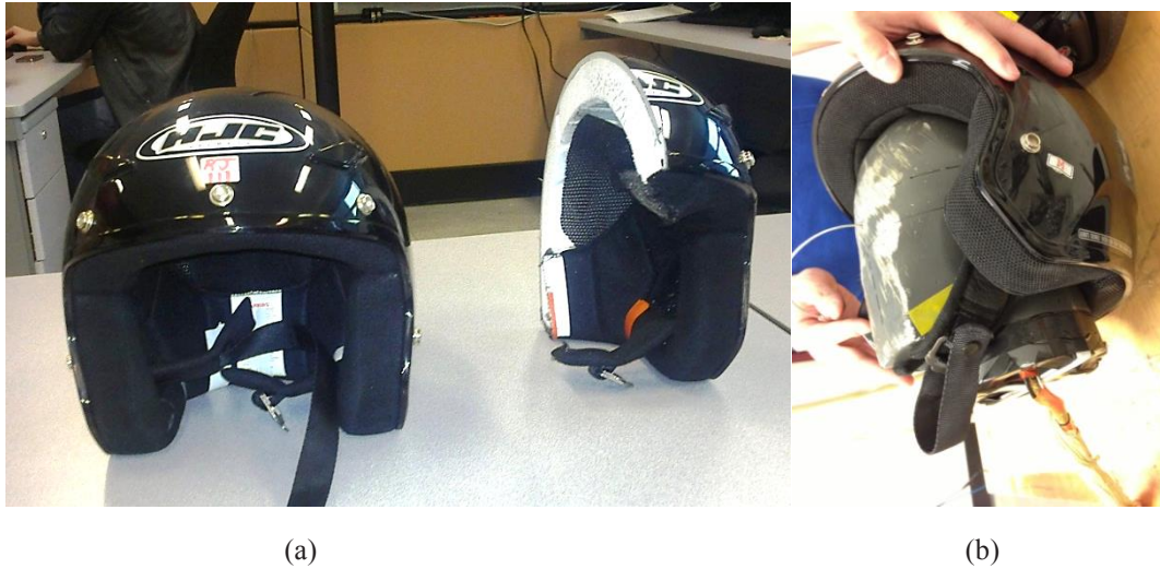
Fig. 10. Tested helmet set (a) Helmet and cut model (b) Full model with head and accelerometer شکل ۱۰: کلاه ایمنی مورد آزمایش (a) نمونه کلاه و مدل برش خورده (b) نمونه کامل همراه با سر و شتابسنج
