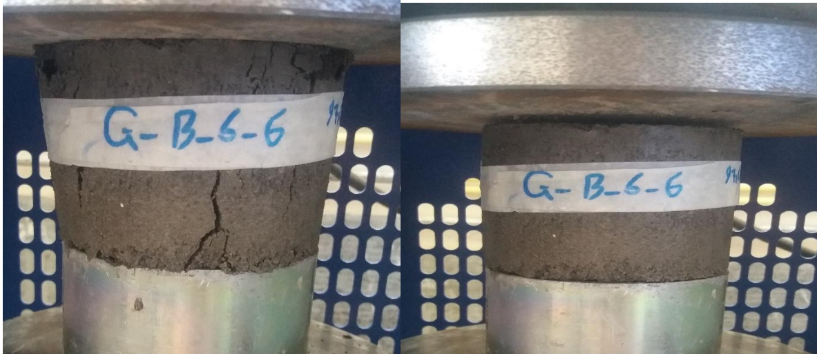
شکل ۴. نحوه بارگذاری بصورت فشاری Fig. 4. Test setup for Compressive Strength
