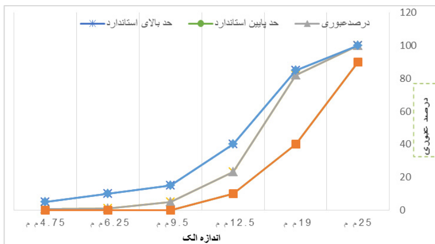
شکل ۲. نمودار دانه‌بندی شن مصرفی
