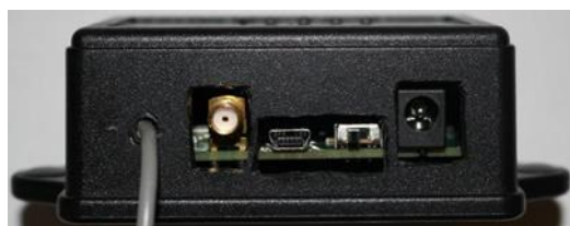
شکل ۳. قاب مخصوص محل قرارگیری مدار طراحی شده. (الف) نمای بالایی مدار (ب) نمایی از قاب به همراه سوکت و دکمه‌های مدار
