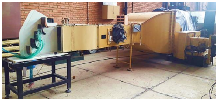
شکل ۴: تونل باد دمشی مورد استفاده در آزمون‌های تجربی
