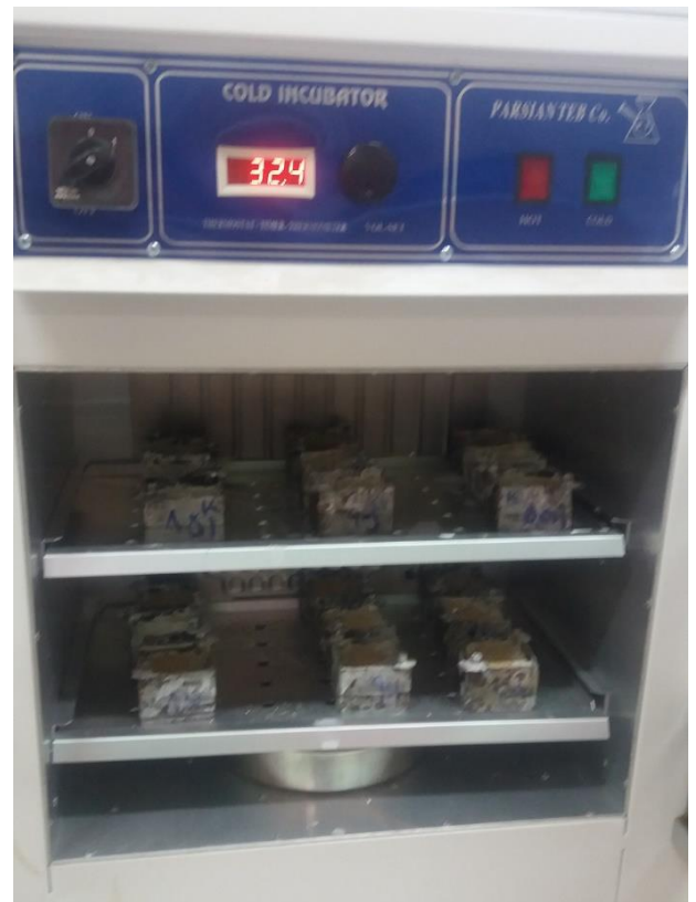
شکل ۵. سلول‌های حاوی نمونه‌های سیمانی سازی شده در دستگاه انکوباتور به منظور عمل آوری آنها
