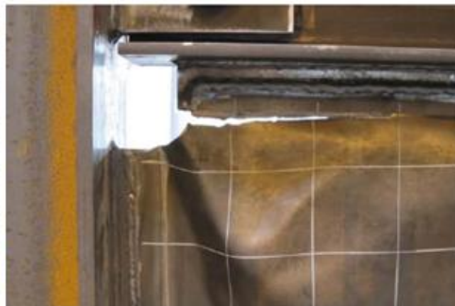
شکل ۳. گسترش ترک در ورق فولادی [۸] Fig. 3. Crack propagation in infill plate [8]
