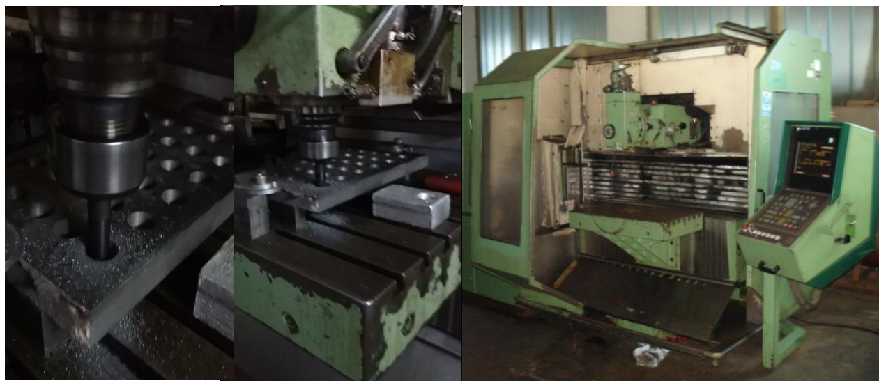
Fig.2. a) Actual view of CNC machine, b, c) Actual thread milling.
