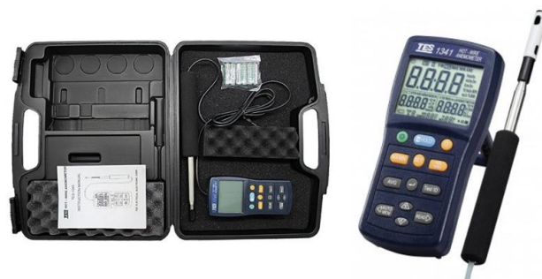
شکل ۱۱. سرعت‌سنج باد مورد استفاده برای به دست آوردن سرعت باد فن شبیه‌ساز. Fig. 11. Wind anemometer used to obtain simulator wind speed
