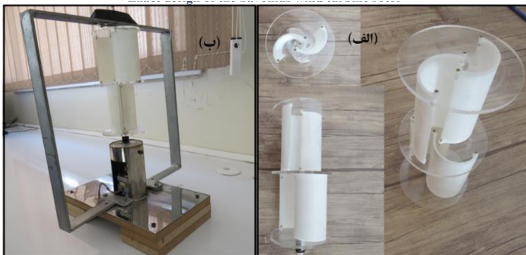
شکل ۶. توربین بادی محور عمودی ساوونیوس (الف) روتور کامل شده توربین از سه نما (ب) روتور توربین به همراه پایه نگه‌دارنده.
