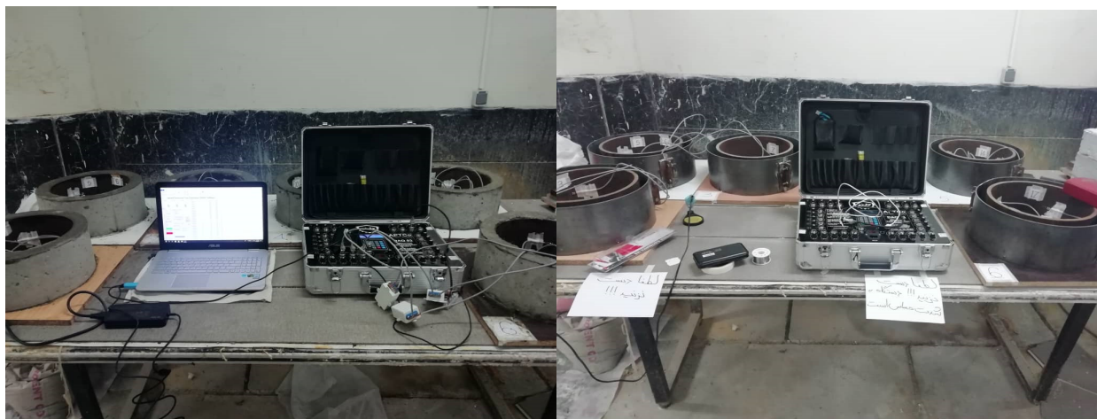
شکل ۲. قالب‌های ساخته شده آزمایش جمع‌شدگی مقید پیش از آزمایش (سمت راست) و در حین برداشت داده در طول آزمایش (سمت چپ) Fig. 2. Specimen mold before test (Right) and molded concrete specimen under Data Acquisition (Left)
