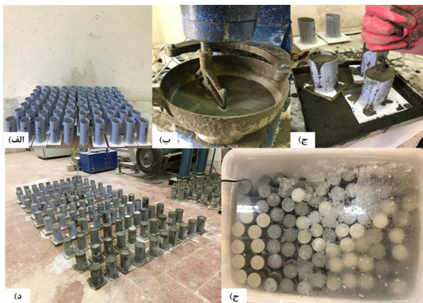
شکل ۲. مراحل نمونه سازی (الف) تهیه قالب مناسب (ب) استفاده از دستگاه همزن جهت مخلوط کردن مواد (ج) ریختن مواد در قالب و متراکم کردن آن (د) نگهداری مخلوط در قالب ها به مدت ۴۸ ساعت (ح) عمل آوری نمونه ها Fig. 2. Stages of the sampling: a) molds, b) mixing with the standard mixer, c) compacting on the mold, d) curing on the basin (2 days), e) curing of the samples
