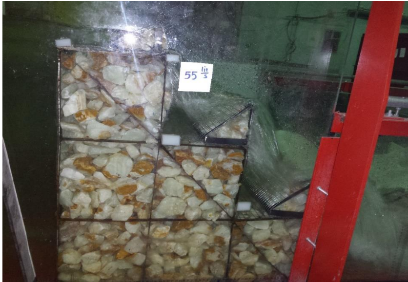
شکل ۵. سرریز ۳ پله‌ای با شیب ۱:۱ و Q=55 lit/s، d_{50}=40 mm آستانه‌های شیبدار ( d_{50}=40 mm، h_a/h_s=0.5 )
