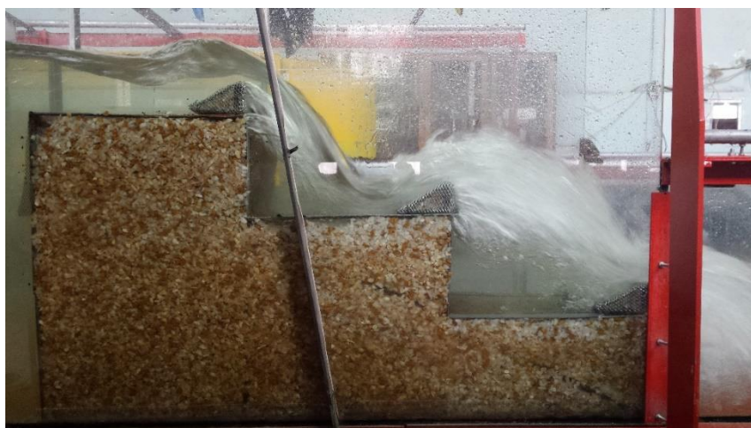
شکل ۴. سرریز ۳ پله‌ای با شیب ۱:۲ و Q=45 lit/s، d_{50}=10 mm با آستانه‌های شیب‌دار ( d_a=10 mm، h_a/h_s=0.25 )
