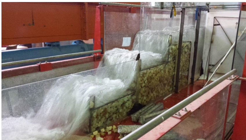
شکل ۳. سرریز ۳ پله‌ای با شیب ۱:۳ و Q=66 lit/s، d_{50}=25 mm با آستانه‌های مستطیلی ( d_a=40 mm، h_b/h_s=0.4 )
