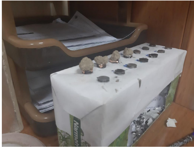
شکل ۵. آماده سازی نمونه‌های تثبیت شده با درصد بهینه از افزودنی به منظور تست SEM Fig. 5. Preparation of stabilized samples with optimal percentage of additives for SEM testing
