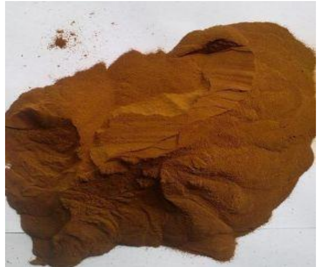
شکل ۲. تثبیت کننده غیر سنتی لیگنوسولفونات کلسیم Fig. 2. Non-traditional calcium lignosulfonate stabilizer
