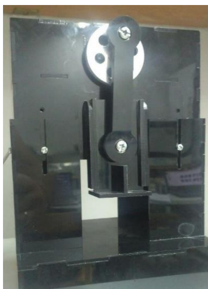
شکل ۴. مولد حرکت خطی Fig. 4. Linear force generator
