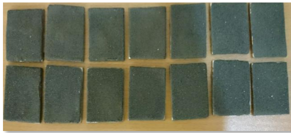
لایه پیش‌نشانی شده در زیرلایه فولاد زنگ‌نزن ۳۱۶ کم‌کربن
