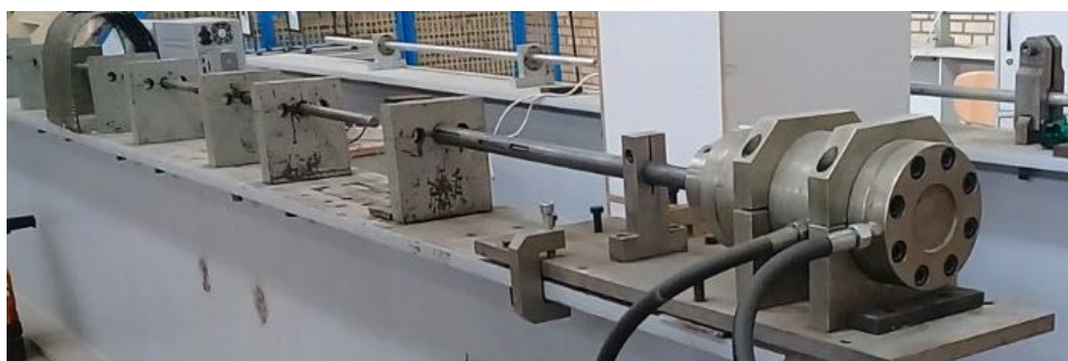
شکل ۱۴. دستگاه آزمایش هاپکینسون.
