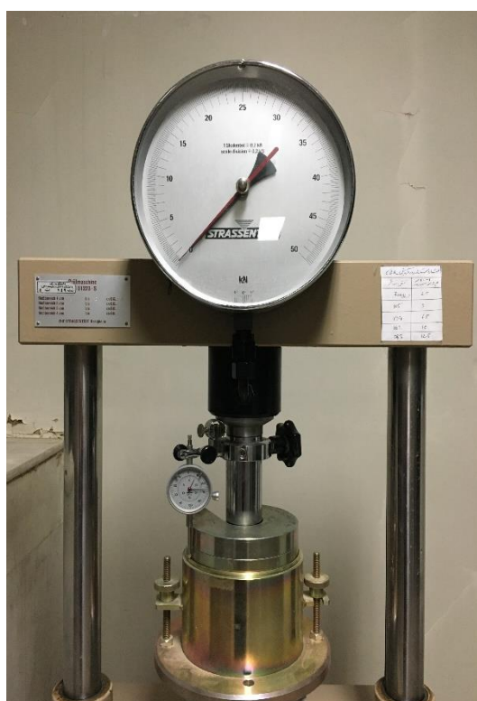
شکل ۴. دستگاه CBR استفاده شده برای آزمایش Fig. 4. CBR apparatus used in experiments
