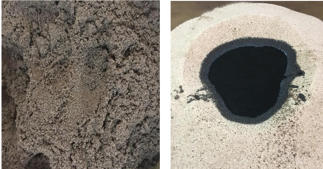
شکل ۵. نحوه‌ی ساخت ماسه آلوده به ۶٪ نفت خام (ماسه فیروزکوه ۱۷۱) Fig. 5. Preparation of 6% oil contaminated sand (FiroozKooH#171 sand)
