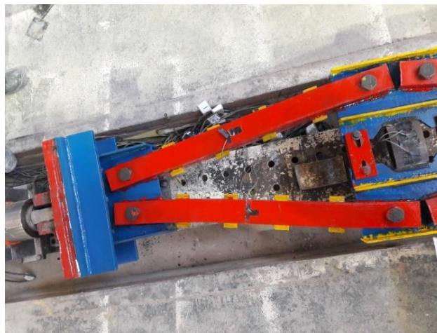
شکل ۱۰. کمانش اعضای مهاربند
