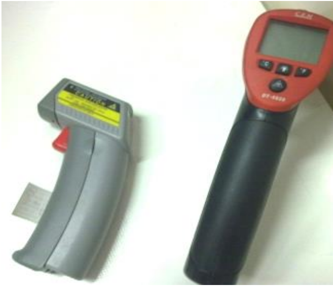
شکل ۴: دماسنج لیزری برای اندازه گیری دمای بدنه و دیوارهای کناری آبگرمکن Fig.4. Laser thermometer to measure body temperature and side walls of water heater
