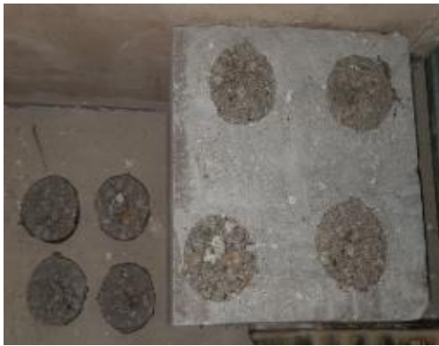
(ب) صفحه‌های فلزی جدا شده از سطح نمونه بتنی
