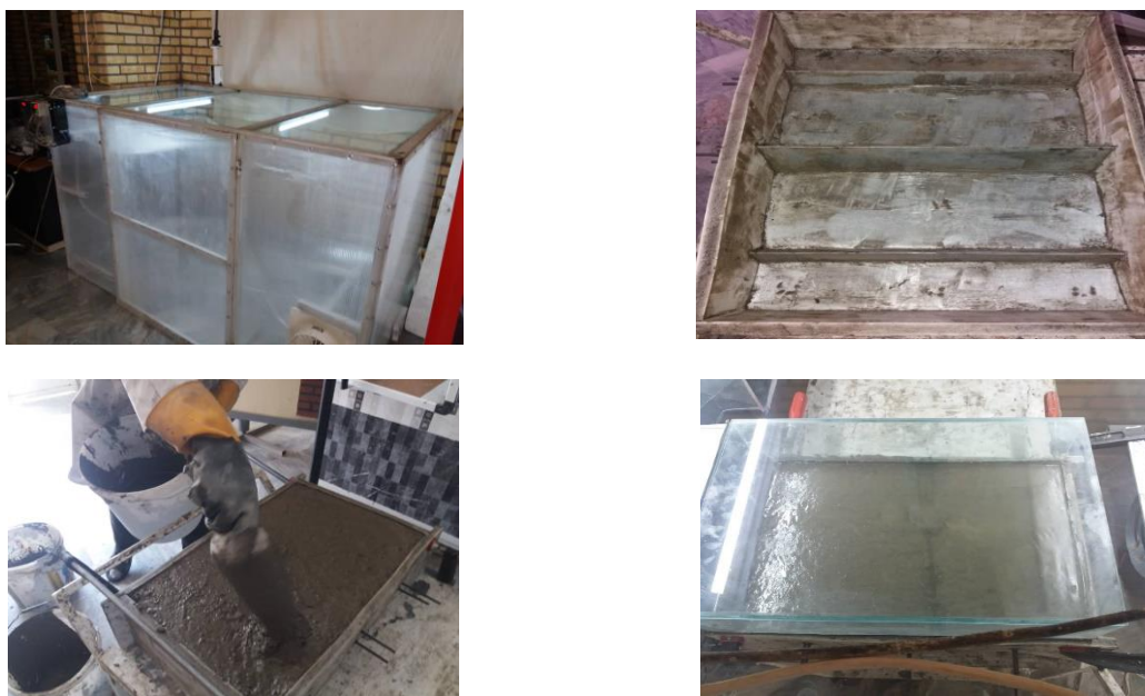
شکل ۴. محفظه‌ی شبیه‌ساز عوامل جوی، قالب آزمایش، آزمون‌گیری و انجام آزمایش
