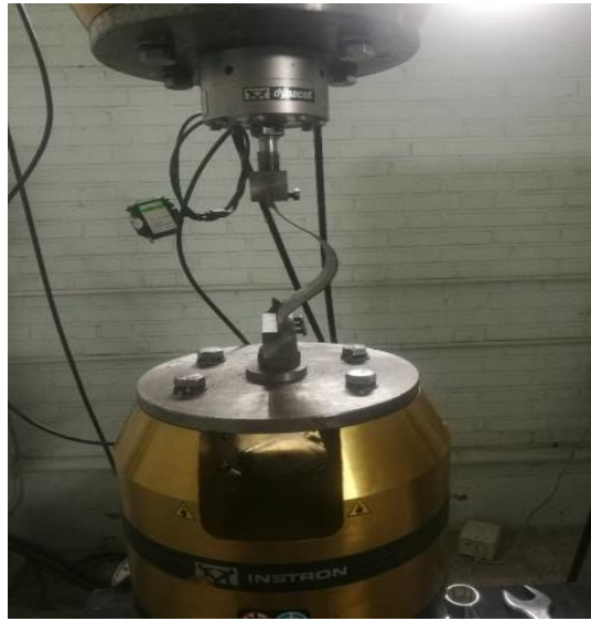
شکل ۵. کمانش ورق کامپوزیتی تحت بارگذاری فشاری
