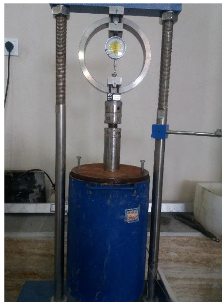
شکل ۴. قالب و دستگاه بارگذاری سلول واحد Fig. 4. Mold and unit cell loading device
