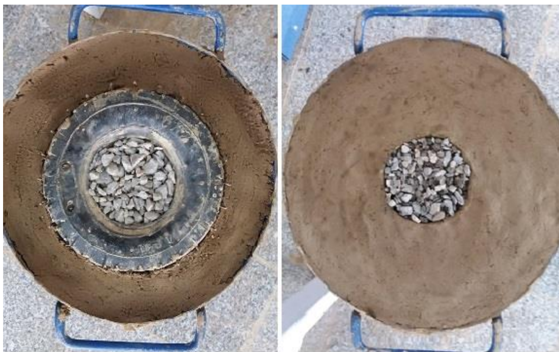
شکل ۵. الف: ستون سنگی محصور نشده ب: ستون سنگی محصور شده با تایر Fig. 5. (a) non-encased stone column; (b) tire-encased stone column
